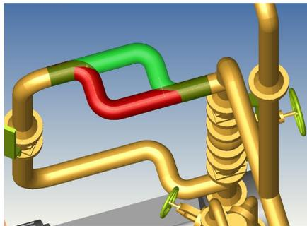
Rohrleitungen können per Drag & Drop dynamisch angepasst werden. Verbindungen zu anderen Komponenten werden automatisch angepasst.
