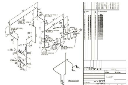
MPDS4-Anwender können Rohrleitungsisometrien mit 3D-Ansichten und Stücklisten automatisch generieren
