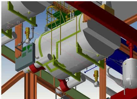
Das Auto-Routing-Werkzeug erlaubt das automatische Planen und Anordnen von Rohrleitungen. Alle betroffenen Verbindungen werden dabei automatisch neu angeordnet.
